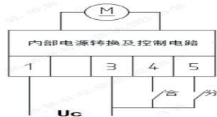
电操接线示意图
